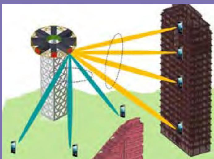
Horizontales und vertikales Beamforming. [Quelle: (2)]
