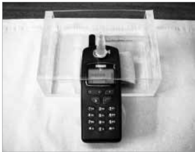
Plexiglashalter für Mobiltelefone. Die Lage des Telefons bleibt konstant und die Position zur Platzierung der Bakterienkulturen ist markiert.
