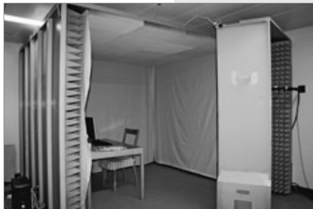
Abbildung 7: Mit Absorbieren versehene Versuchskammer. Die Antenne ist rechts im Bild. Figure 7: Experimental chamber with absorbers. The antenna is placed on the right-hand side.
