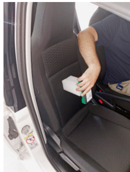
Messgerät für niederfrequente Magnetfelder auf einem Rücksitz. Da die Stärke von EMF-Feldern nach Ort variiert, wurden drei Positionen ausgemessen: direkt an der Rückenlehne, circa fünf Zentimeter von der Lehne entfernt, zehn Zentimeter 10 von der Lehne entfernt. (Bild: Fields at Work)
